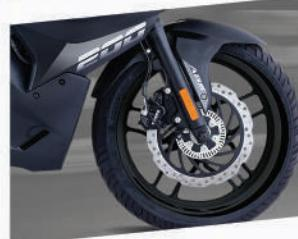
• **SISTEMA DE FRENO ANTIBLOQUEO DE UN SOLO CANAL**
